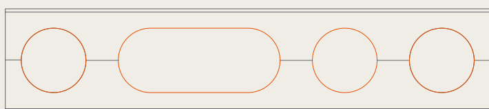
Figura 10: Ejemplo de viga ACB® con abertura alargada
